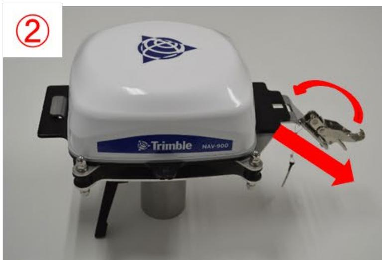
② 反対側にある取付金具でベースマウントプレートに固定します。
