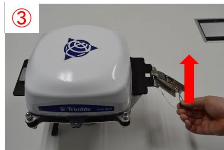
③ アンテナブラケットの固定金具を用いてマウントベースプレートを固定します。
