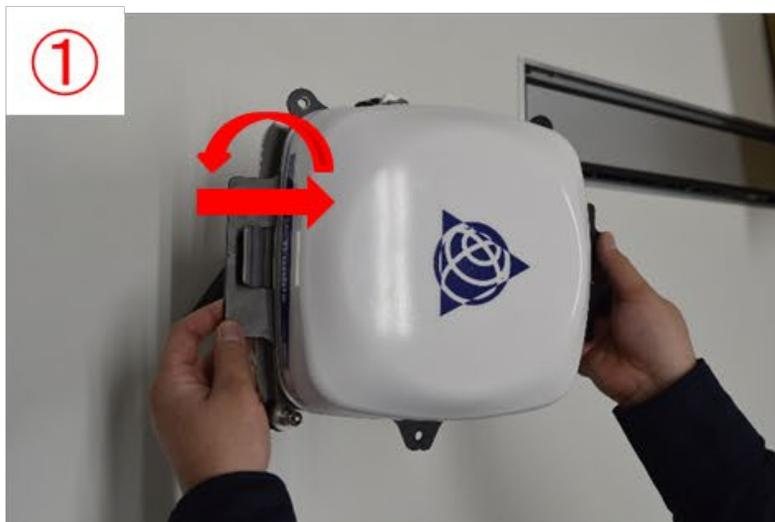
① 治具の爪部分をベースマウントプレートに引っ掛け、Trimble NAV-900を治具の上に乗せます。
