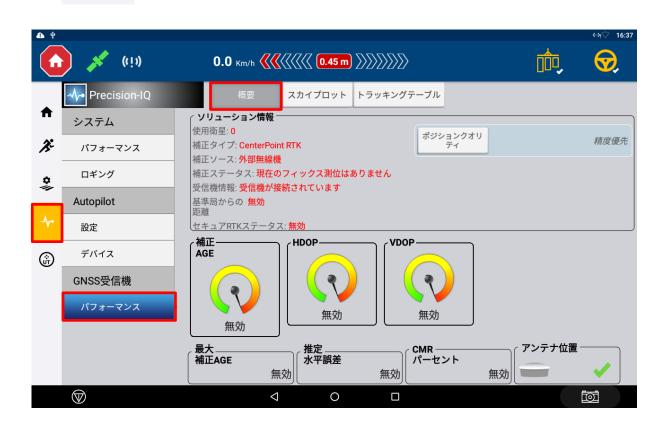
· 「HDOP」:水平精度劣化度
