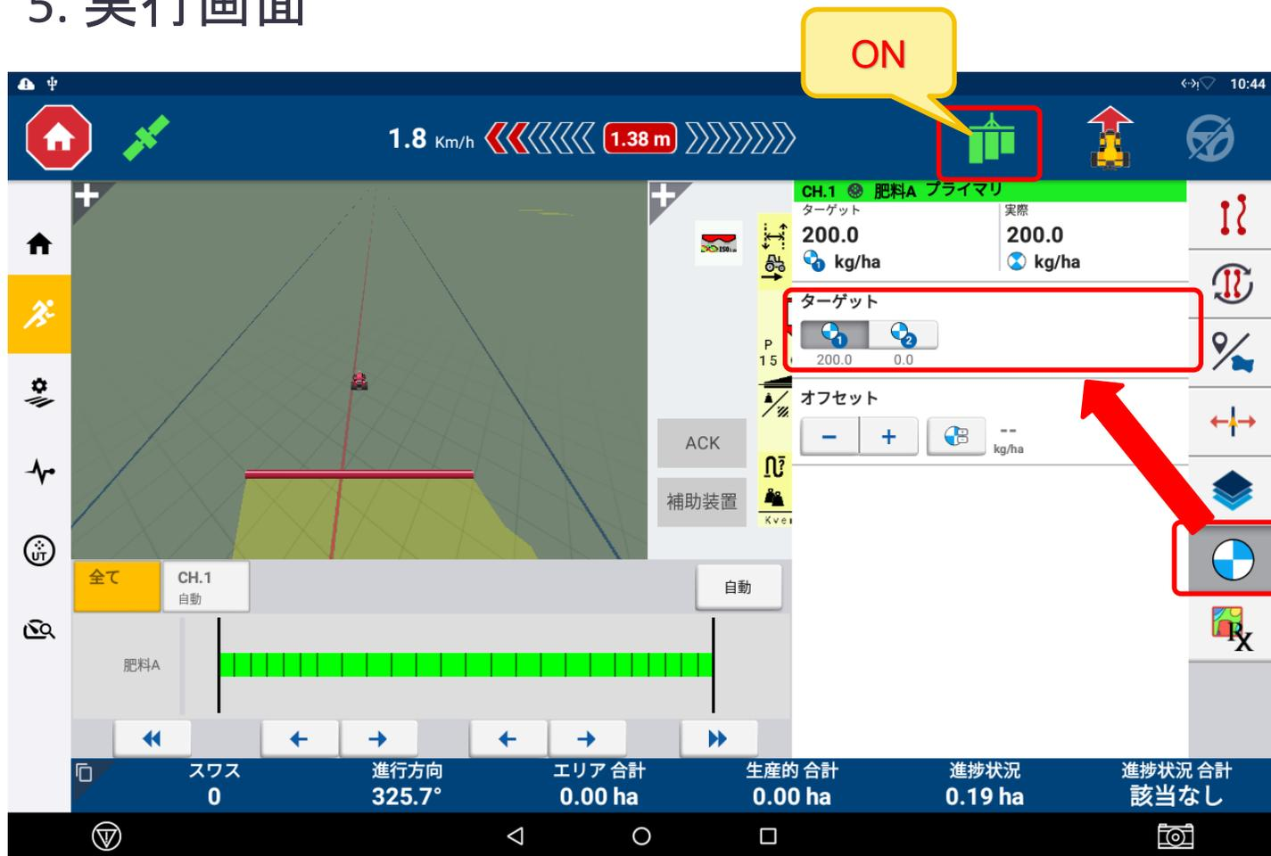
・ 目標散布量を設定し色塗りONで散布開始
