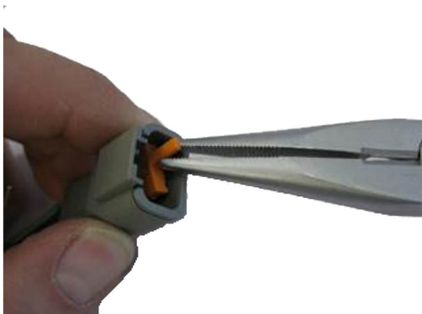
3. フットスイッチの場合、ロックを上向き、黒い導線を右側、黄色の導線を真ん中、緑色の導線を左側にして、レセプタクルを固定します。
