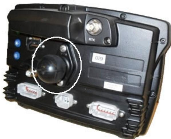
2. RAMマウントを、ひし形マウントプレート上のボールに取り付けます。
