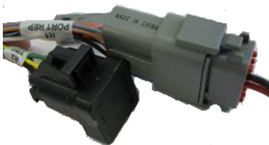
メモ - ソナーアラートを使用しているときは、エンゲージピン10を取り外して、ピン8に移す必要があります(リモートエンゲージ機能がピン8とピン11の間で稼動し、ソナーアラートがピン2とピン10の間で機能するようにするため)。
