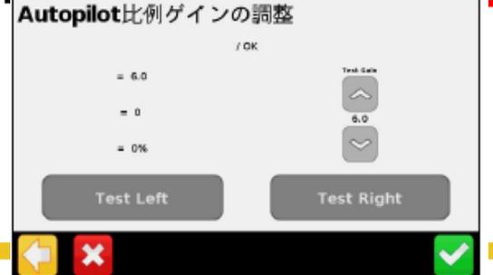
Pゲインの調整:トラクタを前進させ A-B をタップします。
