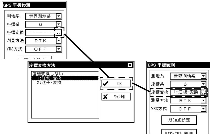
観測コマンドの起動画面内で登録済みの「座標変換データ（パラメータ）」を選択して観測を行えば、図面には座標変換計算後の座標値が登録されます。
