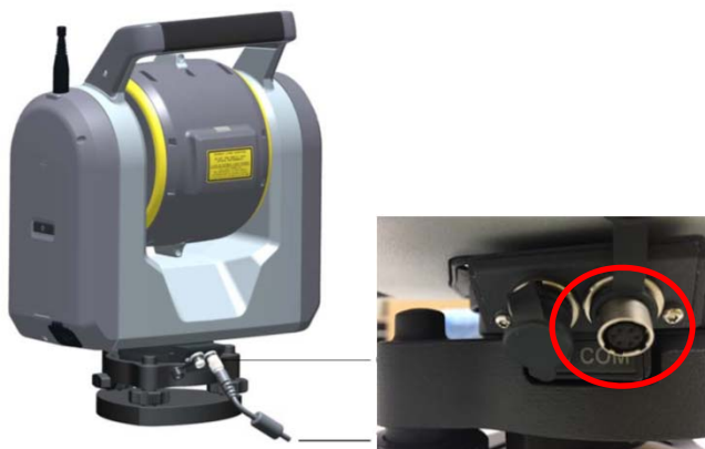
Trimble SX10 側は COM と書かれたポートにケーブルを接続
