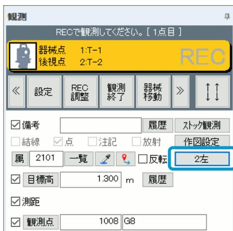
平行線が設定された場合、「観測」画面の《平行設定》ボタンに設定内容の概略が表示されます。
