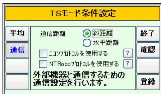
※「NTRobo プロトコル」を使用する時は、通信距離の設定は行えません。(通信距離は、斜距離となります)
