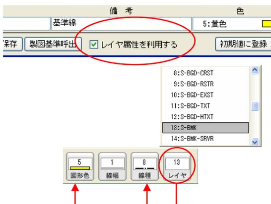
レイヤ毎に色・線種の属性が規定されているCAD製図基準に準拠した図面を効率よく作図できるよう、レイヤ主体の属性切り替えモードを設けました。
