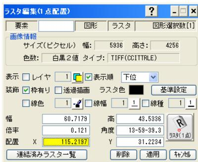
従来のバージョンでは、ラスタを回転配置する場合、回転させたラスターデータを再作成してから配置する仕組みでしたが、ラスターデータをダイレクトに回転して配置できるよう改良しました。
