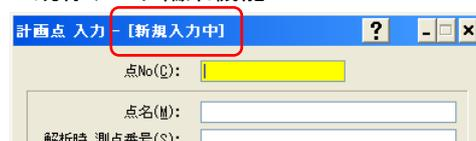
編集対象とする計画点の点 No を入力するか、パート図上でクリックすると、データ編集モードに切り替わります。
