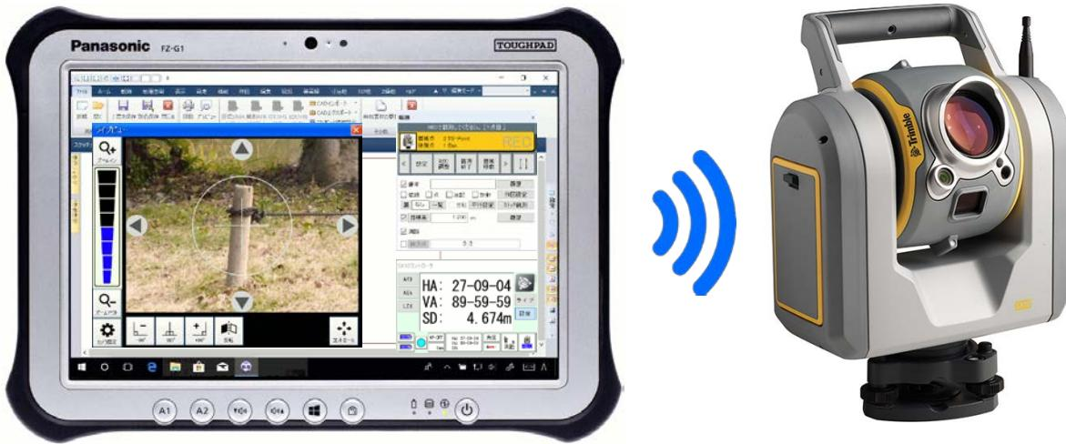
「Trimble SX10」には接眼レンズや画面表示が存在しないため、「GUIDER ZERO」上でストリーム映像の表示や、操作を行うための専用コントローラを搭載しました。「GUIDER ZERO」上で「Trimble SX10」のすべての操作が行えます。
